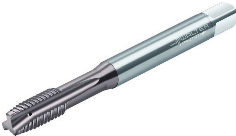
σχήμα 21 - Κοιλαούζο από καρβίδιο με εσωτερικές διόδους ψυκτικού
