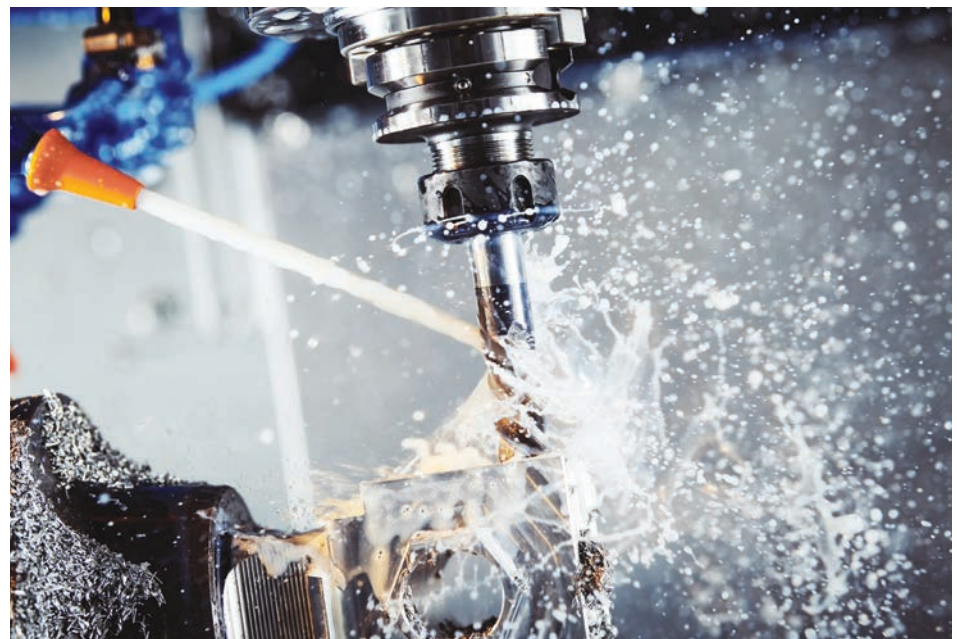
σχήμα 6 - Κατά τη διάτρηση οπών σε εργαλειομηχανή CNC συνιστάται η εφαρμογή του υγρού κοπής με ψεκασμό ROCOL
