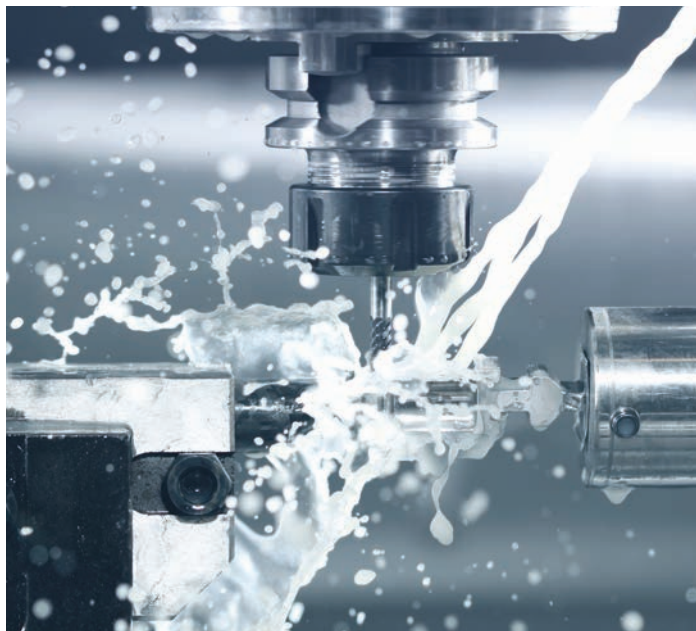
σχήμα 7 - Κατά την τόνρευση προτιμάται η πλούσια παροχή υγρού
