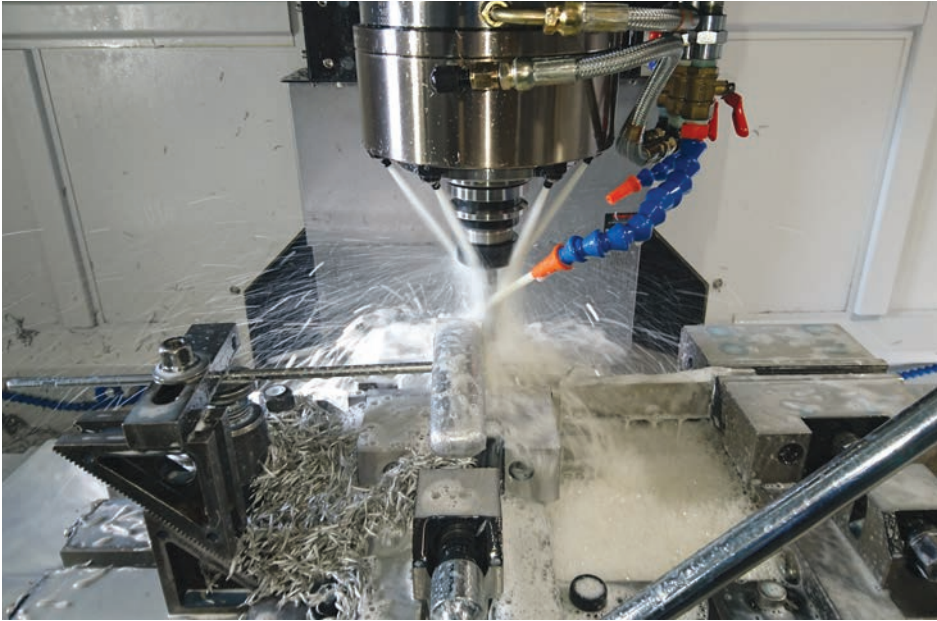
σχήμα 5 - Στις εργασίες φρεζαρίσματος CNC το υγρό κοπής λειτουργεί καλύτερα όταν πέφτει με πλούσια ροή στην περιοχή εργασίας AKIRA SEIKI
