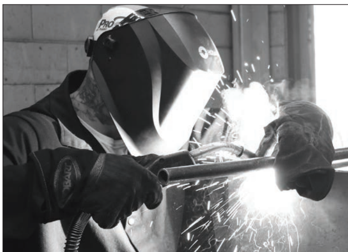
↑ Σχ.4 Η συγκόλληση τόξου με σωληνωτό σύρμα με πάστα εσωτερικά (FCAW) είναι μια εξαιρετικά αποδοτική και παραγωγική διαδικασία συγκόλλησης.
